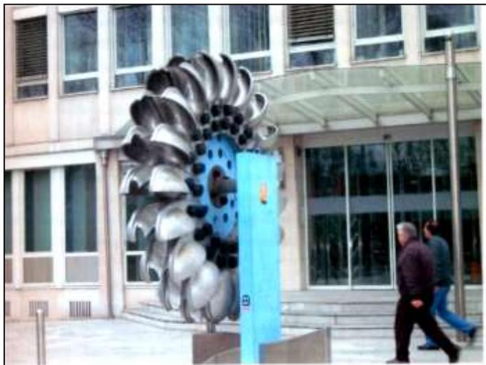
**Bild 24: Laufwerk einer zweidüsigen Pelton turbine vor dem Gebäude der Tauernkraftwerke AG. in der Bahnhofstrasse in Salzburg (Aufn. des Verf. Dezember 2002).<sup>99</sup>**
