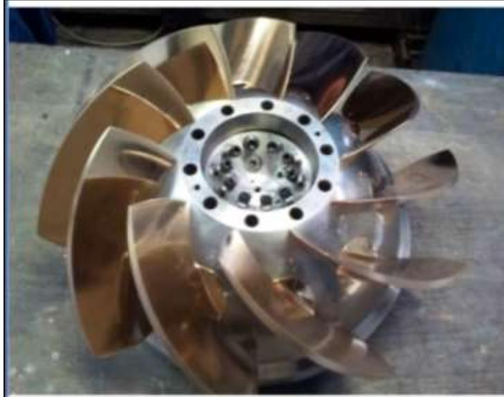
Bild 199: Laufwerk einer Diagonalturbine (Deriaz turbine) der Fa. Geppert.
